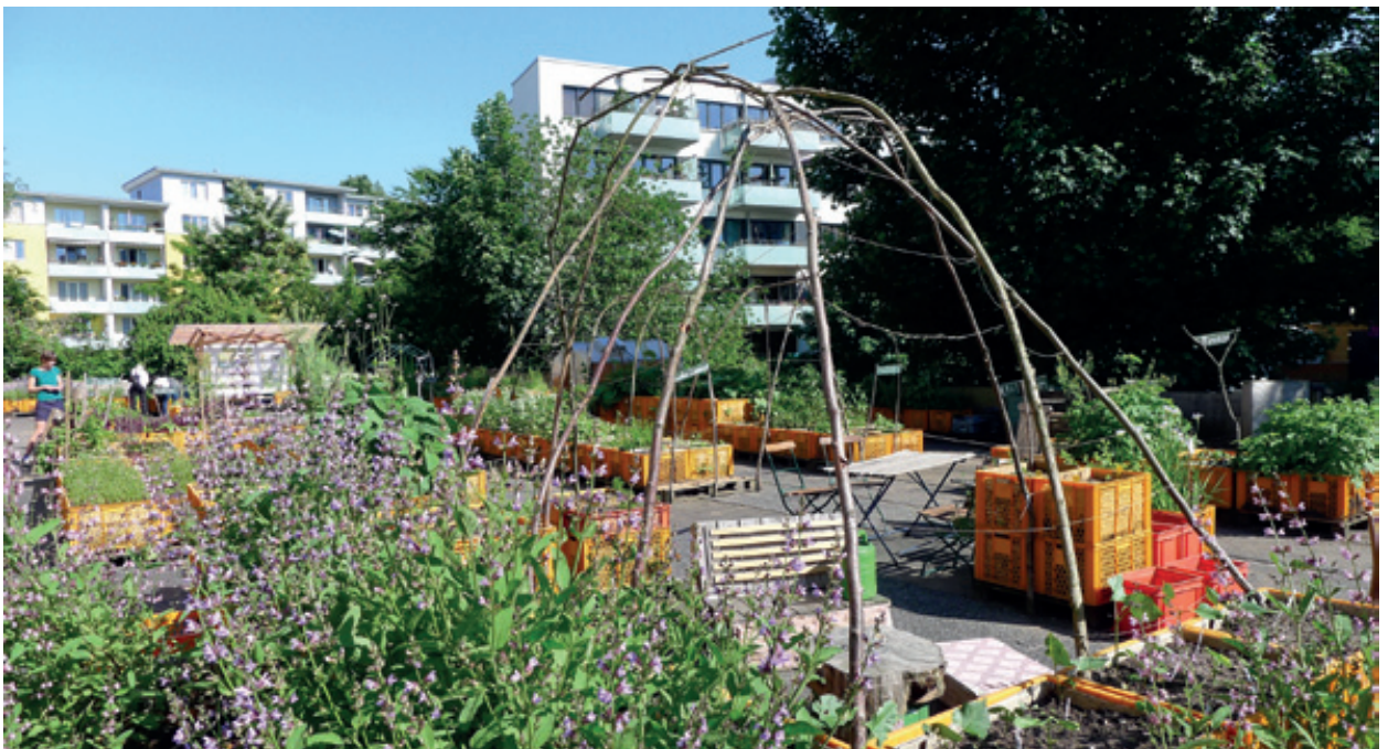
Gartendeck St. Pauli, Hamburg: Hier wird auf dem Dach einer Tiefgarage gegärtnert. Die vorherige Nutzung als Stellfläche für Autos erlaubt aus statischer Sicht auch die Nutzung als Gemeinschaftsgarten. Allerdings musste die Oberfläche abgedeckt werden.
